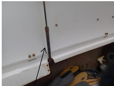
Photos 4, 5, 6 : plateforme, vérin corrodé
