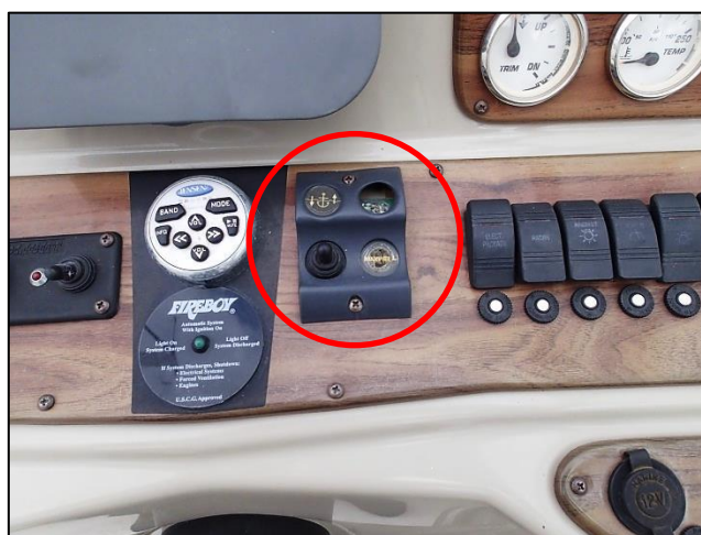
Photo 10 : commande guindeau non étanche
